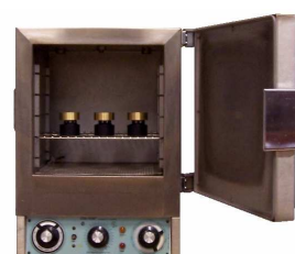
Zeitverfestigung von 3 Proben in einem Klimaschrank
